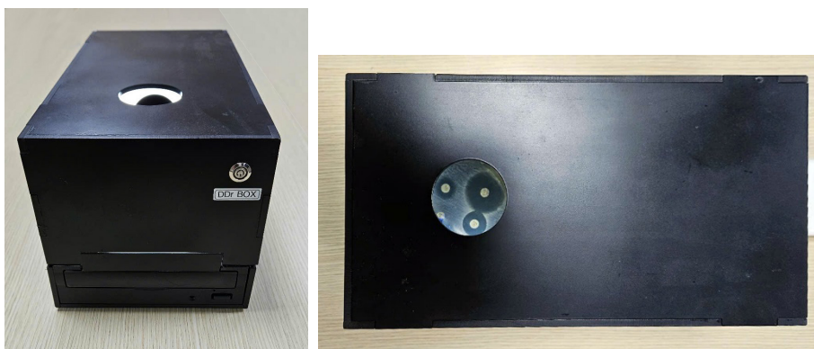
Hình 1. Thiết bị DDr Box sử dụng để tạo môi trường chụp ảnh bằng điện thoại di động kết quả kháng sinh đồ phương pháp Kirby-Bauer sử dụng trong nghiên cứu.
